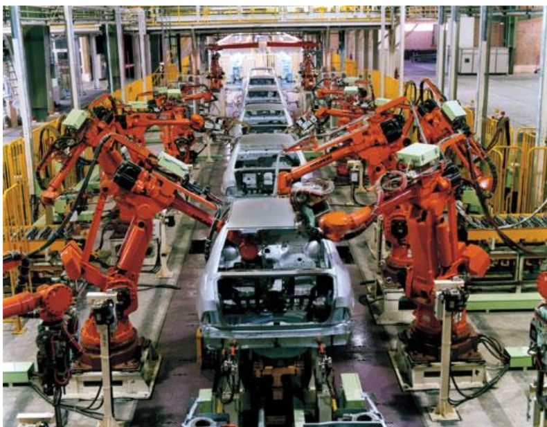
Zautomatyzowana linia produkcyjna samochodów.
